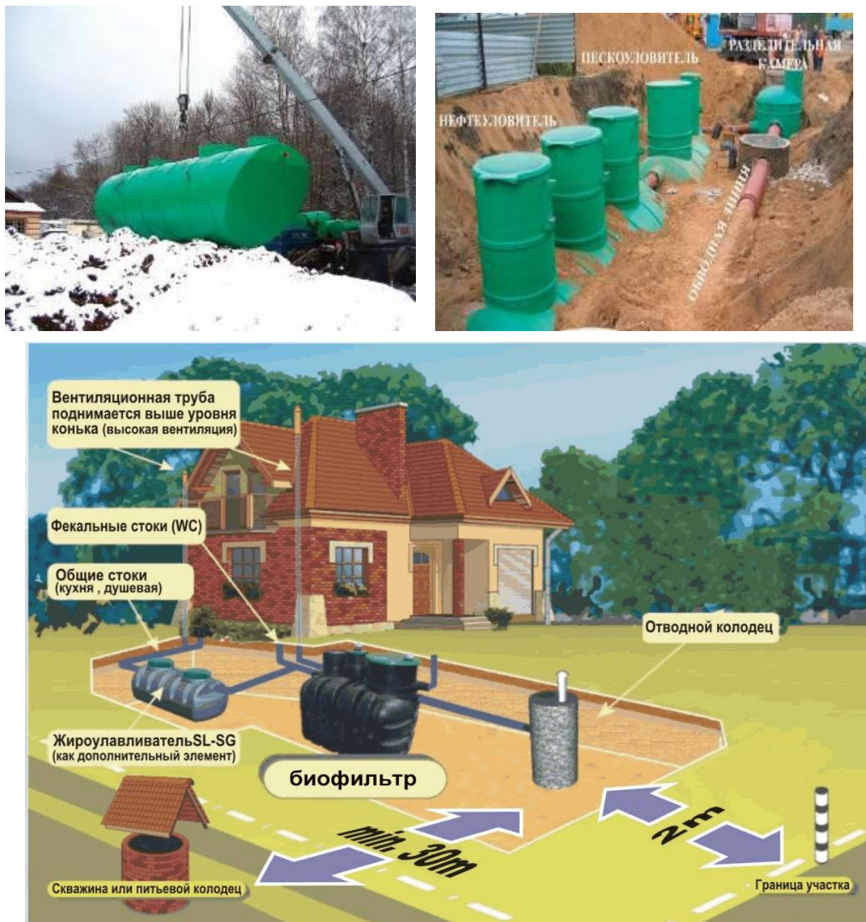
Рис. 8.1.2. Пример устройства автономной канализации
