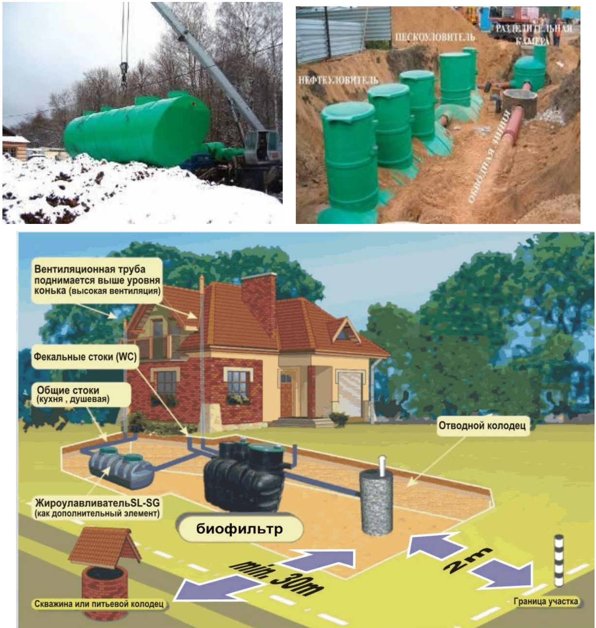
Рис. 8.1.2. Пример устройства автономной канализации
